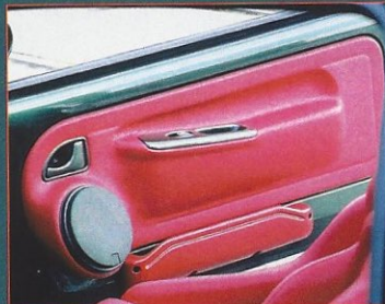
Verkleidete Türtafel mit ausgeformtem Einbauplatz für 16er Tieftöner
