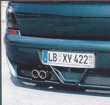
Modifizierte Heckstoßstange von SK-Tuning ohne Stoßleiste, doppelte 80-mm-Endrohre am Remus-Sporttopf
