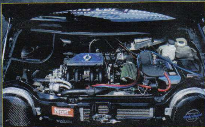
Hier ist Lachen drin: der 1,2 l Motor wird durch eine N2O-Anlage gedopt
