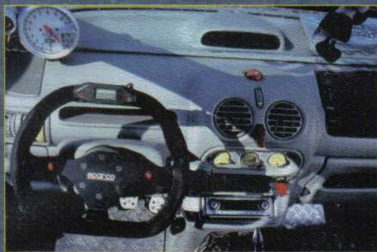
Sparco-Lenker, Drehzahlmesser mit Shiftlight Riffelblech und Killswitch im Cockpit
