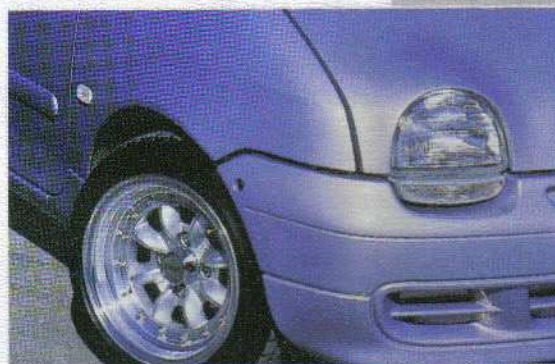
Semmelrath rüstet den Twingo mit 8x13 Zoll-Roadster-Felgen samt 175/50er Pneus aus.
