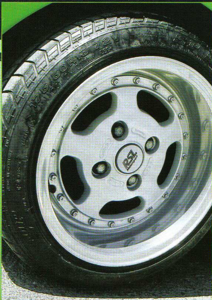
Die RSL-Felgen waren schon mal auf einem VW Polo montiert. Die Dimensionen lauten: 7 x 13 ET 5 an der Vorderachse und 8 x 13 ET -13 hinten. Verchromte Verschraubung und polierte Betten verleihen den Klassikern von RSL einen kräftigen Glanz
